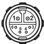
PIN 1 : BRUN (N/A) PIN 2 : NOIR (N/A) PIN 3 : ROUGE (DATA +) PIN 4 : VERT (DATA -) PIN 5 : BLANC (GND) PIN 6 : BLEU (PGM)
